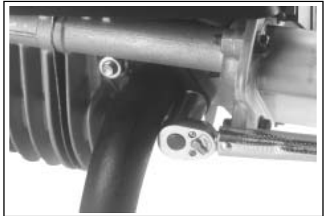
Kuva 10-78. Pakoaukon laippamutterien kiristys.
