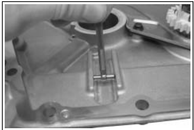
Kuva 9-7. Ohjainkanavan mittaus suojalevyssä.
