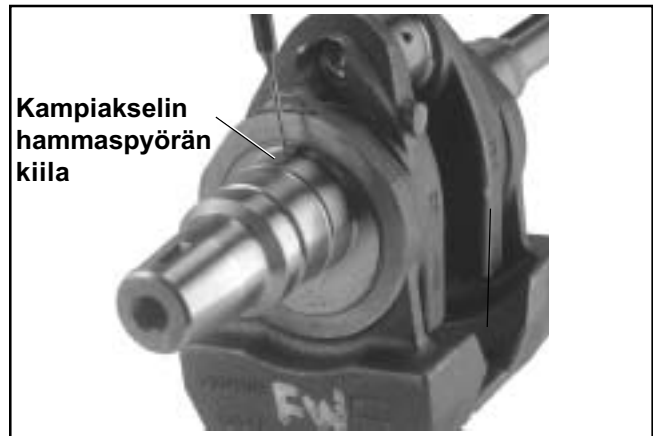
Kuva 10-13. Kampiakselin hammaspyörän kiilan asennus.
