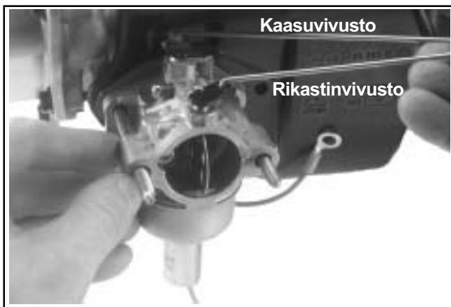
Kuva 10-55. Kaasuttimen ja vivuston asennus.
