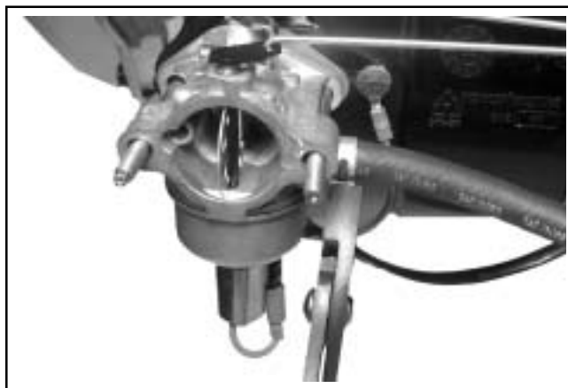
Kuva 10-58. Polttoaineletkun yhdistäminen kaasuttimeen.
