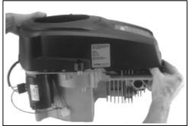
Kuva 10-70. Puhaltimen kotelon asennus.
