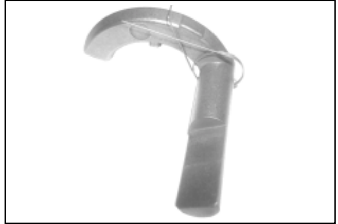
Kuva 10-23. Jousi asennettuna puolipuristimen painoon.
