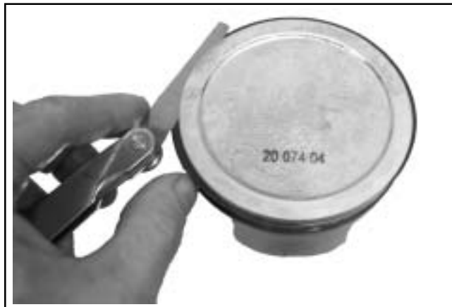
Kuva 9-14. Männänrenkaan sivuvälityksen mittaus.
