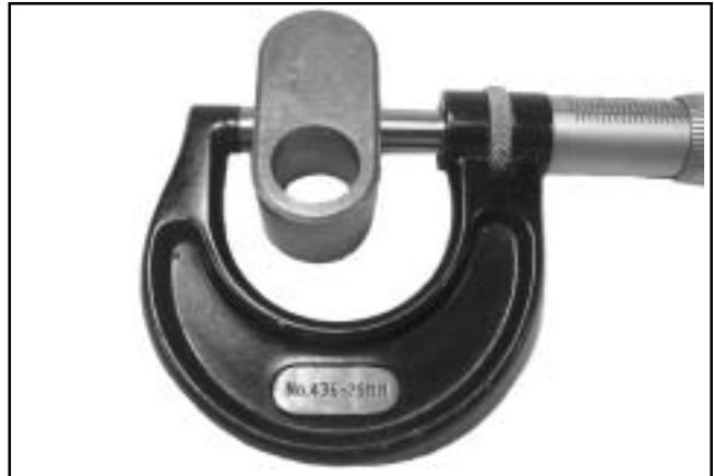
Kuva 9-6. Vastapainon ohjainkengän mittaus.
