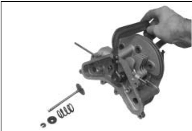
Kuva 8-34. Venttiilien irrotus jousenpuristimella.
