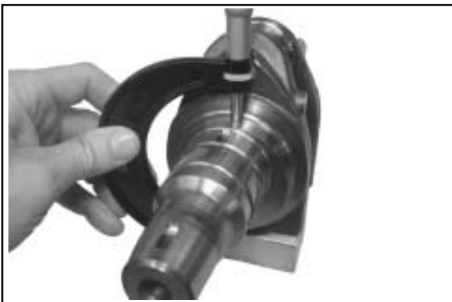
Kuva 9-5. Kampiakselin epäkeskon mittaus.
