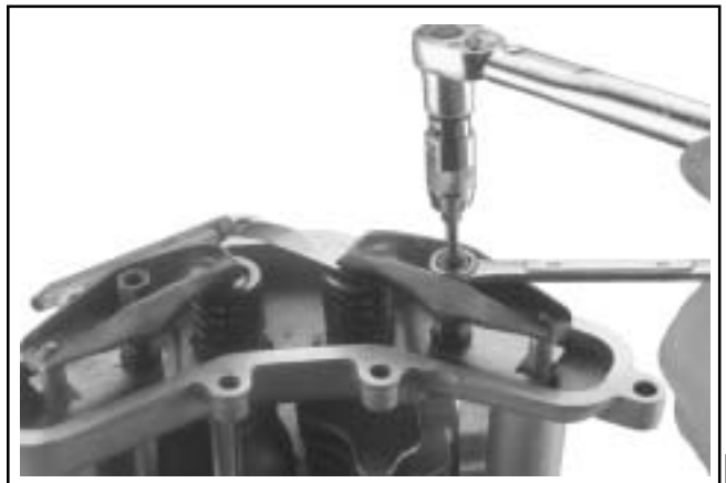
Kuva 10-40. Säätömutterin ruuvin lukitus.
