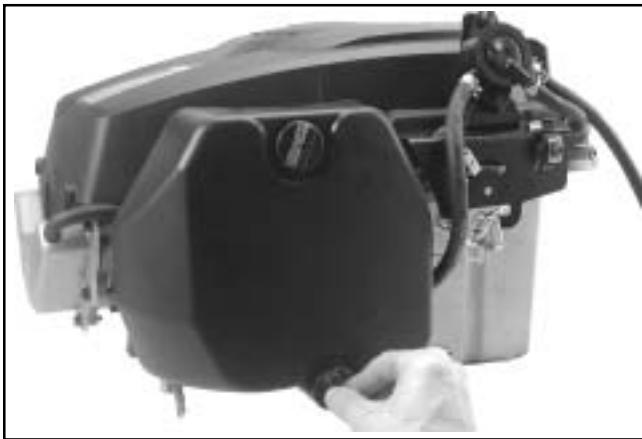
Kuva 10-77. Ilmanpuhdistimen kannen asennus.
