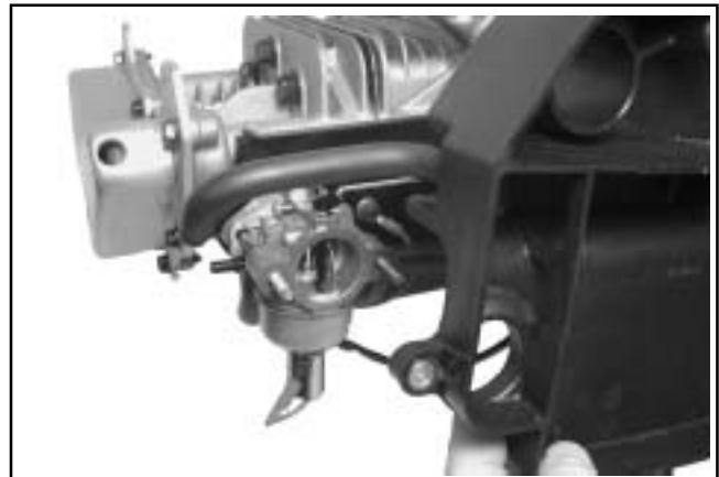
Kuva 8-10. Ilmanpuhdistimen pohjan ja huohotinletkun irrotus.
