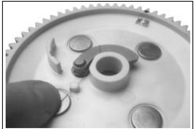
Kuva 10-24. Puolipuristimen jousen kiinnitys pakonokkapyörään.
