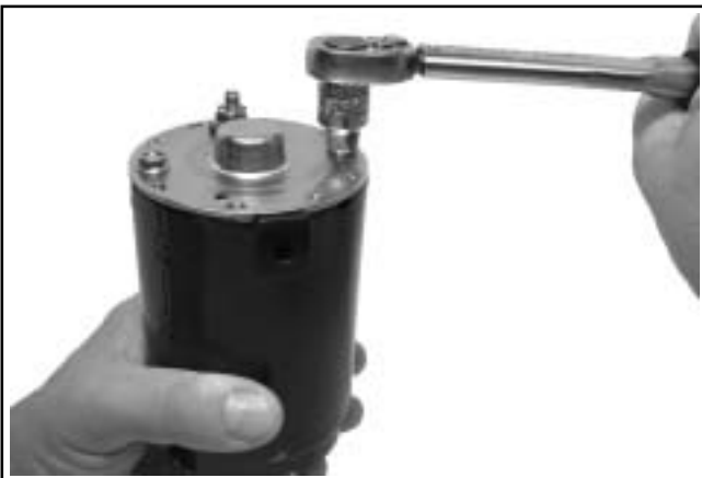
Kuva 7-22. Läpimenevien pulttien kiristys.
