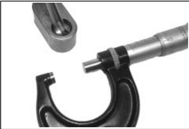
Kuva 9-9. Ohjainkengän reiän sisähalkaisijan mittaus.
