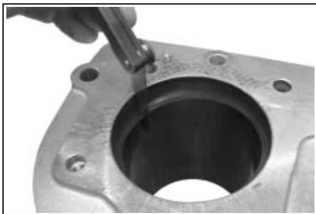
Kuva 9-13. Männänrenkaan päiden välin mittaus.
