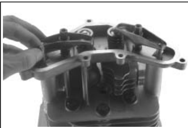
Kuva 10-38. Työntötankojen ja venttiilinvipujen asennus.
