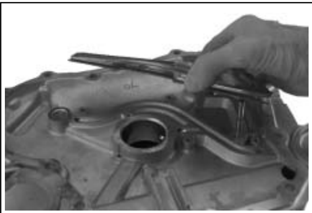
Kuva 8-38. Öljykanavan kannen ja tiivisteiden irrotus.
