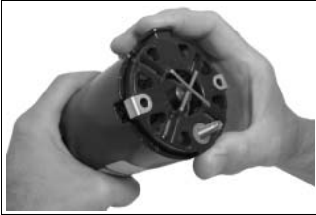
Kuva 7-21. Hiiliharjan kannattimen asennus pidikkeitä käyttämällä.
