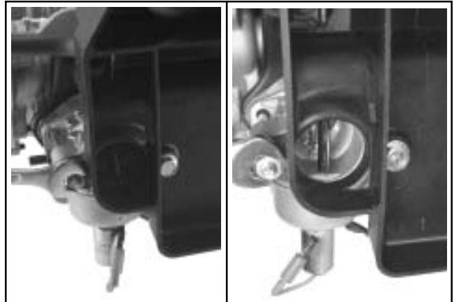
Kuva 8-9. Ilmanpuhdistimen pohjan kiinnikkeiden irrotus.
