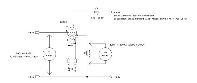
FOR 6C33C TUBE BRAKE IN PROCEDURE:
